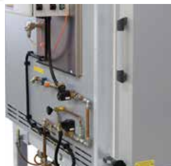
Plynová trasa a termočlánek na peci
