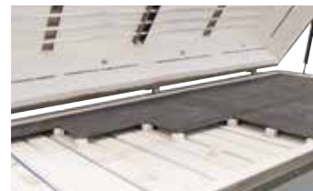
Vytápění dna pro rovnoměrné prohřívání větších objektů jako doplňkové vybavení.
